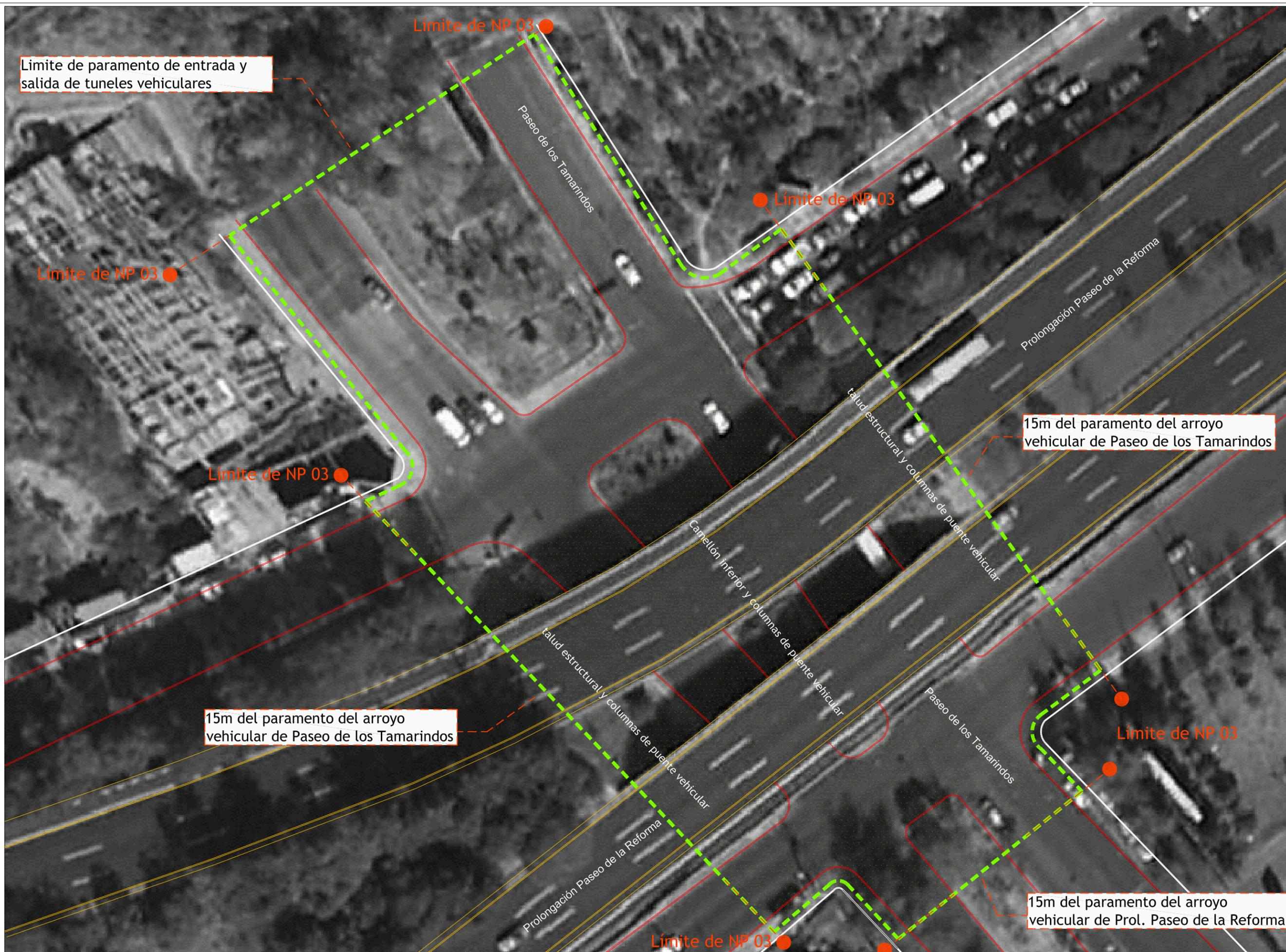
Límite de paramento de entrada y salida de tuneles vehiculares
