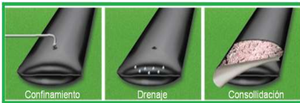
Fig. 19. Etapas del tratamiento de descargas residuales en geocontenedores.
