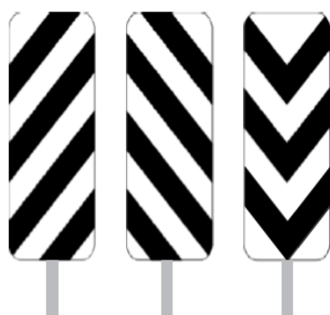
INDICADOR DE OBSTÁCULOS: Indica a los conductores de vehículos la existencia de obstáculos o de una bifurcación.
