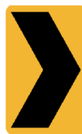
INDICADOR DE CURVA PELIGROSA: Guía a los conductores de vehículos en su desplazamiento por una curva pronunciada con respecto a la geometría predominante.
