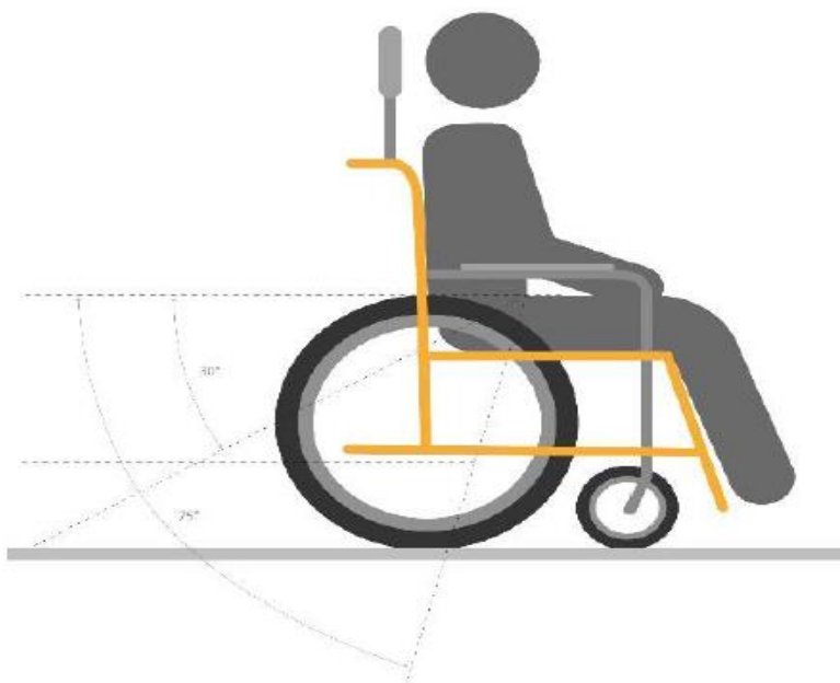
Figura 2. Ángulo de colocación del cinturón pélvico del vehículo
