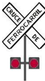
SEMÁFORO PARA CRUCES CON VÍAS FÉRREAS: Previenen a los conductores de vehículos de la aproximación de un cruce a nivel con una vía férrea.
