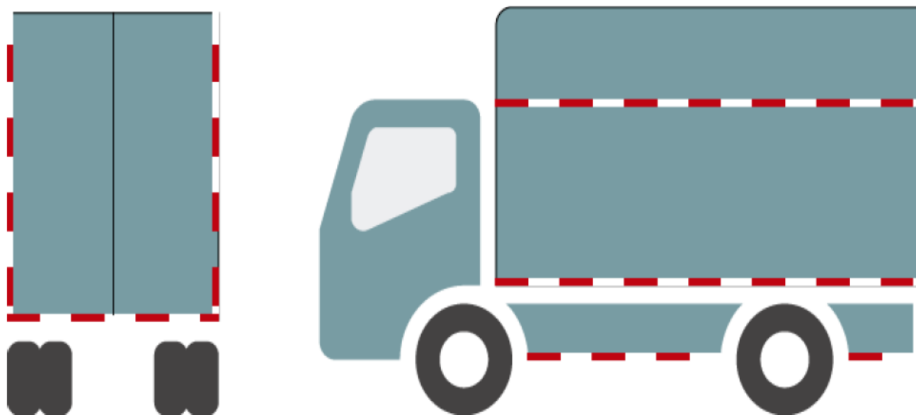
Figura 5. Ejemplo de colocación de cintas reflejantes en vehículos de carga
