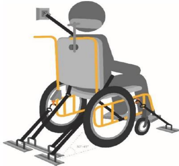
Figura 1. Sistema de sujeción de cuatro puntos
