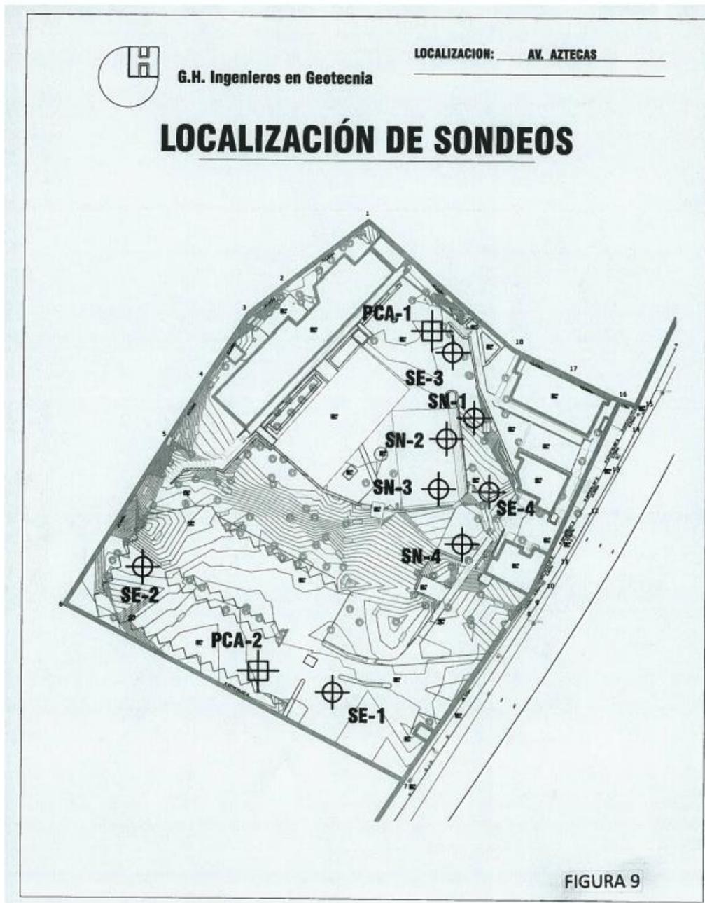
Figura 2. Localización de sondeos de Mecánica de Suelos realizados en el predio (tomado de G. H. Ingenieros en Geotecnia, S. A. de C. V., 2014).
