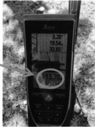
Imagen 1: se observa un inmueble de 6 niveles con una altura de 13.70 metros lineales.
