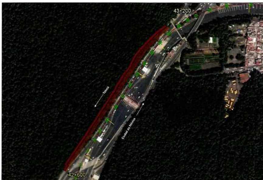
2.- Ampliación de carril en carretera federal mediante afinamiento de talud Aviso de modificación del proyecto en su tramo correspondiente al PK 41+150 al PK 57+876.706
